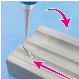
ペイツトーンで、溝に合わせて、ブルストロークでシャープニングします。
