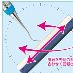
砥石を先端の丸い輪郭に合わせて回転させる
